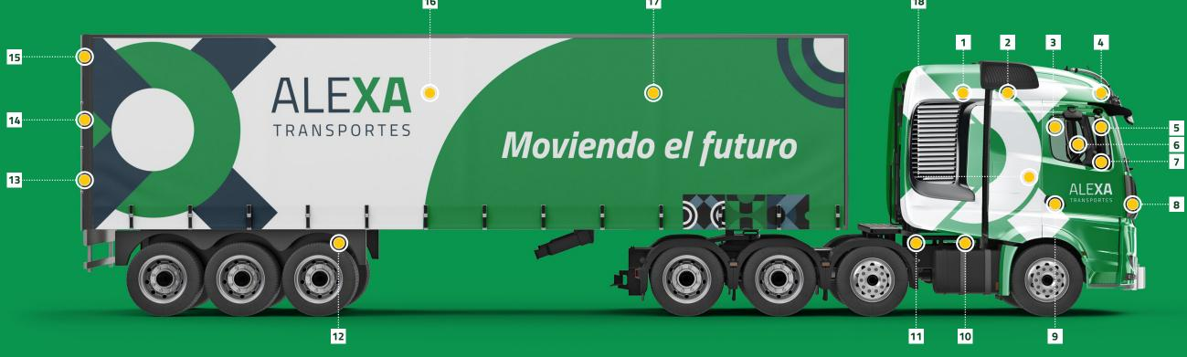
1 Anti Jammer · 2 Equipos Gps · 3 Kit de Voz · 4 Keeper Antena Externa · 5 Cámara Interior 6 Activación de Claxón y/o Luces · 7 Cámara Lateral 8 Paro / Bloqueo de Motor 9 Pinos de Apertura de Puertas · 10 Dvr Móvil
